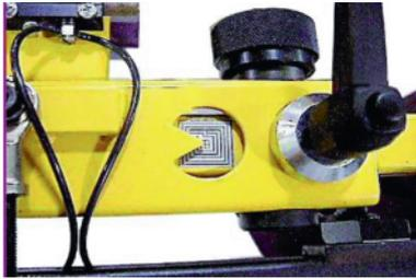
Micro regolazioni per posizionare il telaio rispetto alla macchina in modo preciso e sicuro
