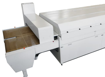
cappa di aspirazione fumi in uscita
