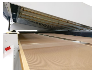
lampade a infrarossi nella prima sezione
