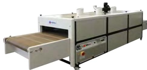
Noir 3750 con sistema ad aria calda forzata e altezza di ingresso del Tunnel maggiorata a 300mm
